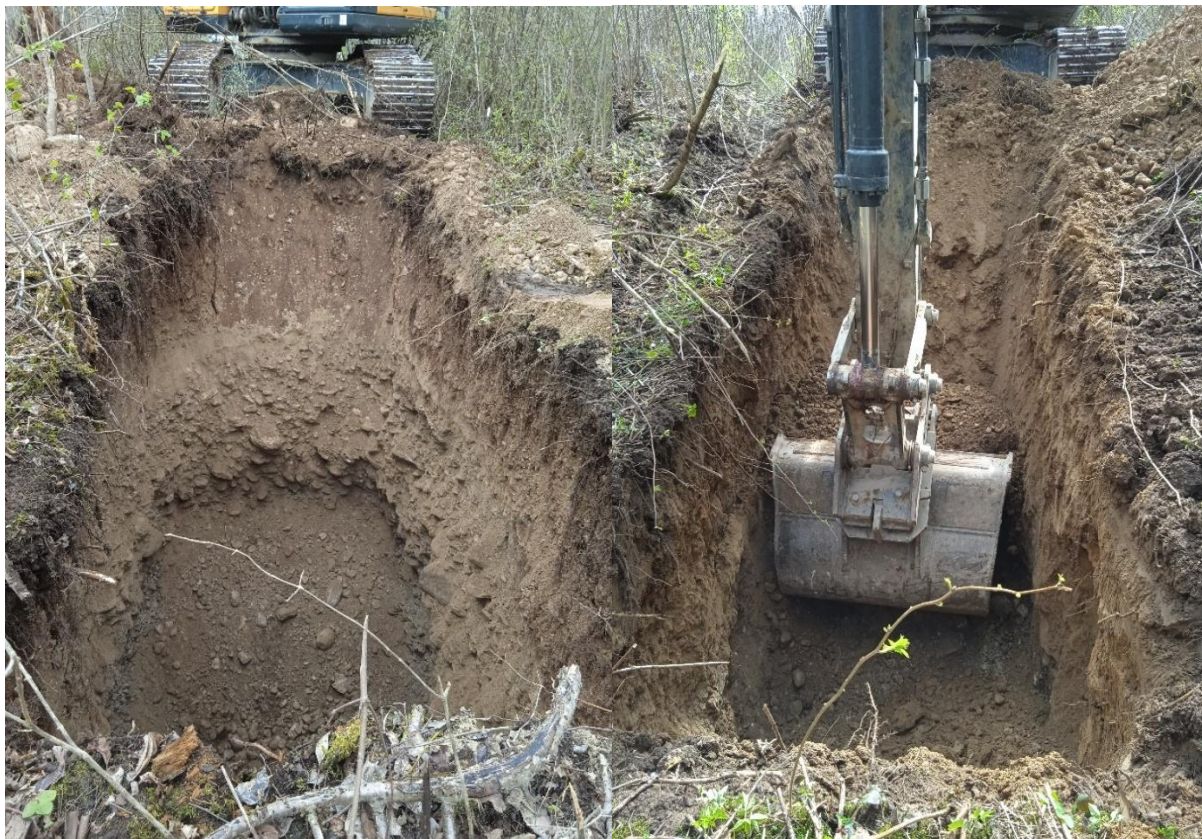
Fotod 3–4. Foto 3 - kaevandis K6 on vaheldumisi ehituskruusa ja rohke kruusaga täiteliiva kihid. Foto 4 - kaevandis K8 on täiteliiv rohke kruusaga.
