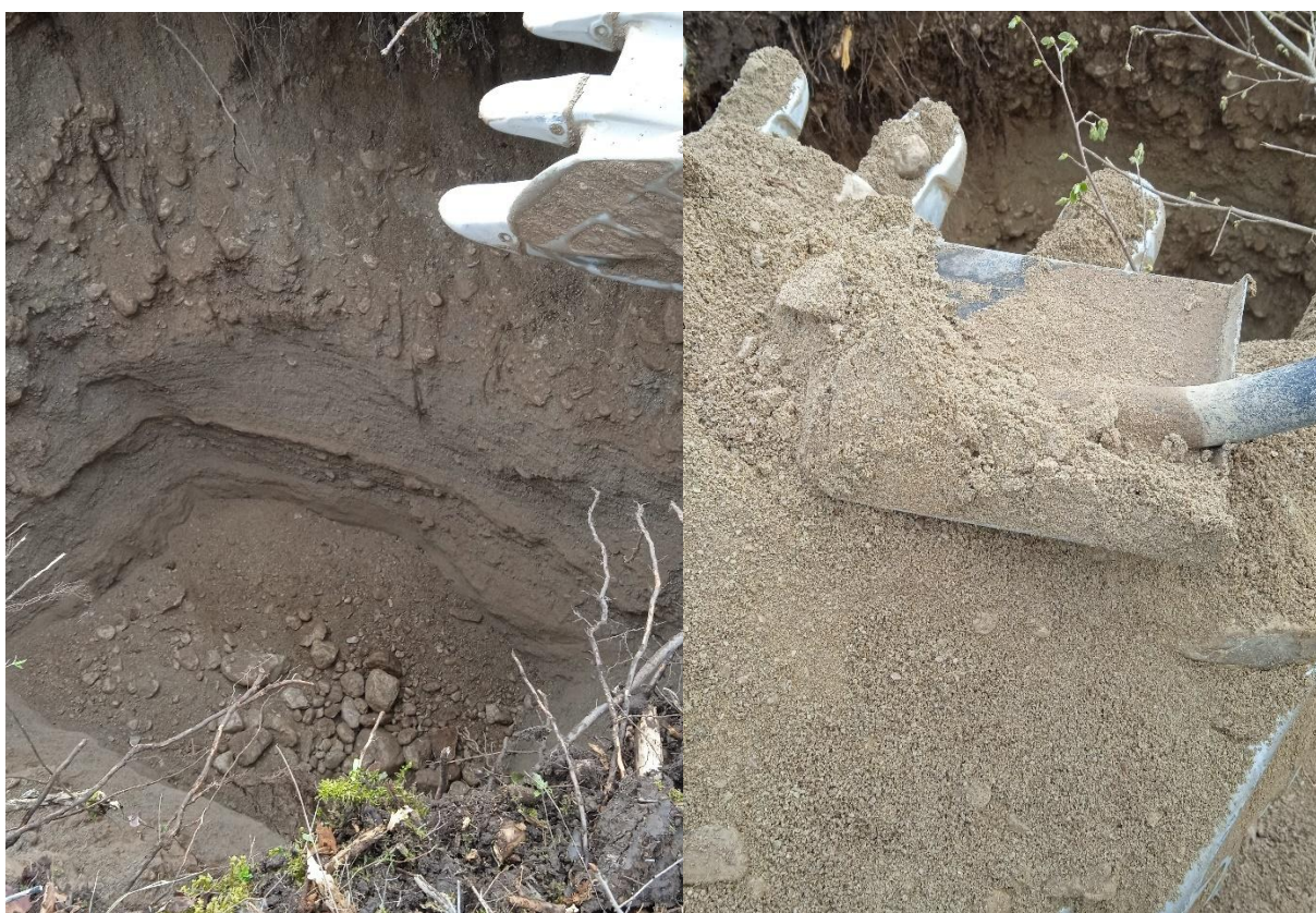
Fotod 1–2. Kaevand K7. Foto 1 - kaevandi ülemistes intervallides on ehituskruus- ja liiv ning alumistes intervallides täiteliiv. Foto 2 - eriteraline täiteliiv.
